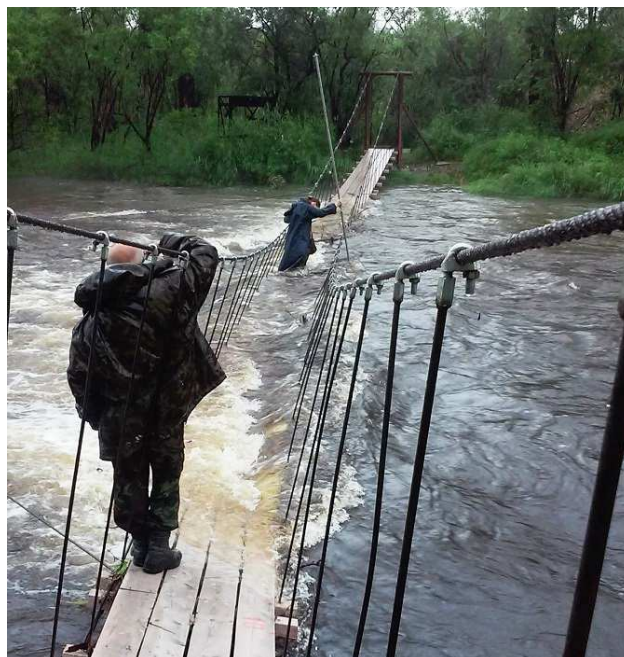
Рисунок 4 Измерение расхода воды в паводок на р. Уптар
